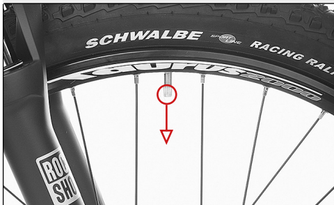
Ventil zeigt zum Laufradmittelpunkt
